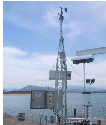
Conjunto meteorológico conectado con la boya AtoN
