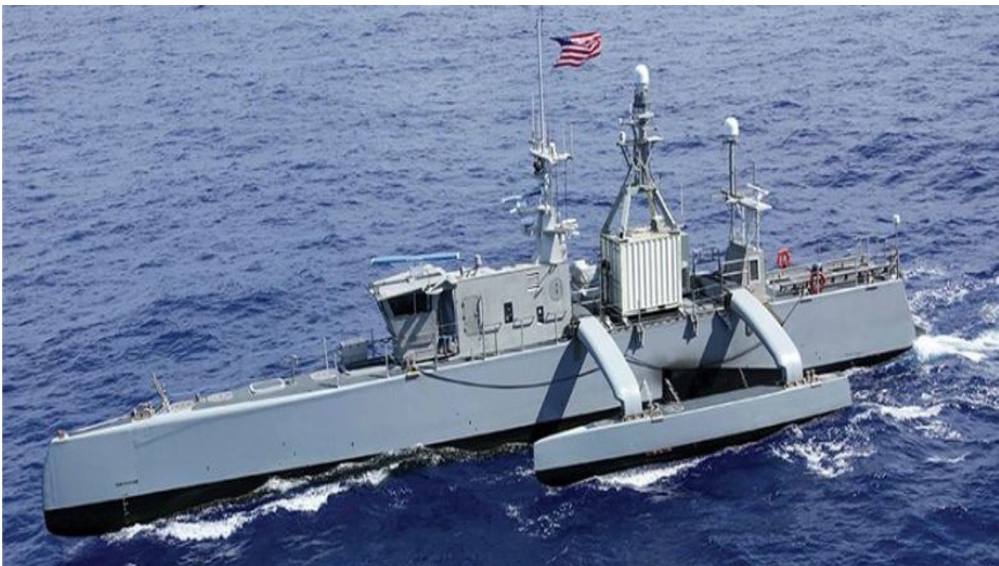
USV Sea Hunter controlado por un destructor de la US Navy a través de comunicaciones satelitales y link 16 durante el RIMPAC - 2022
