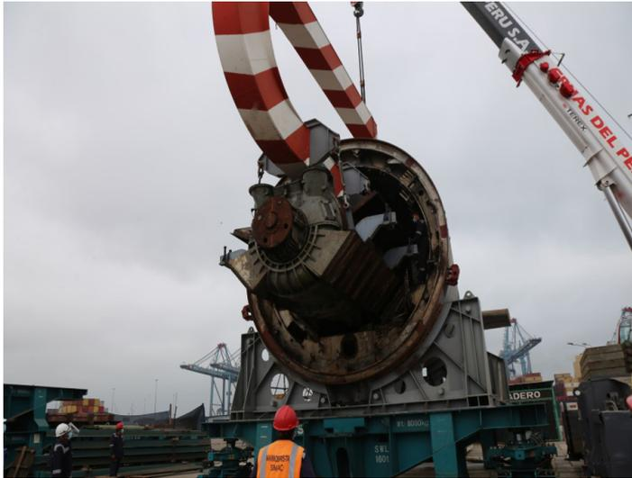
Retiro de motor a propulsión del B.A.P. *Chipana*.
