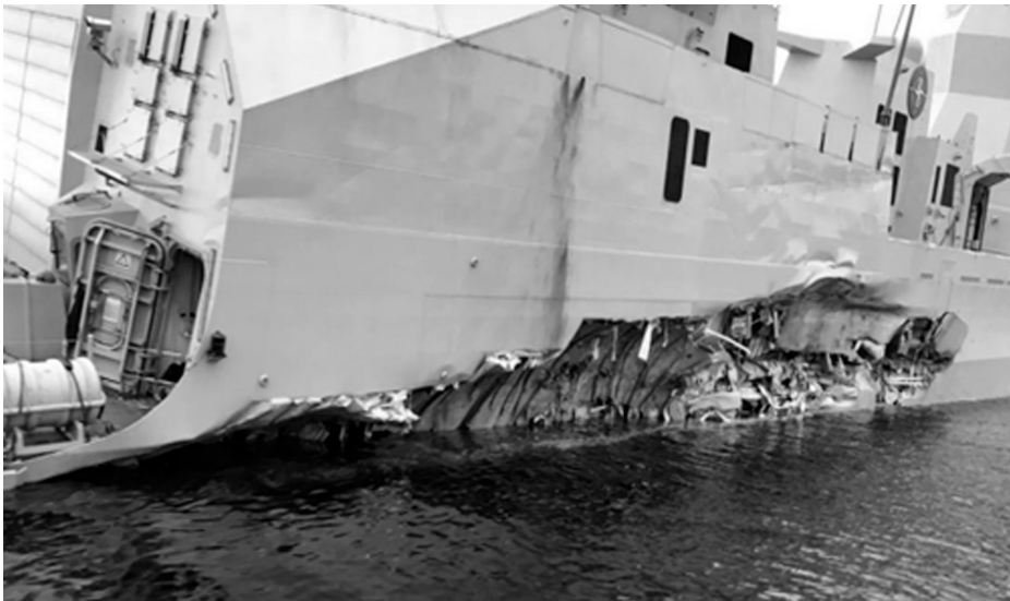
Figura 3. Daños de la fragata HNoMS Helge Ingstad . Imagen obtenida de https://www.aibn.no/Marine/Published-reports/2021-05-eng?WAF_IsPreview=true
