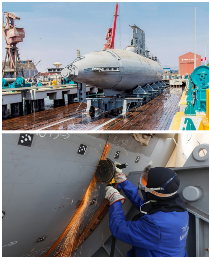
Ingreso del B.A.P. Chipana al sincroelevador del SIMA-Callao y corte del casco resistente.
