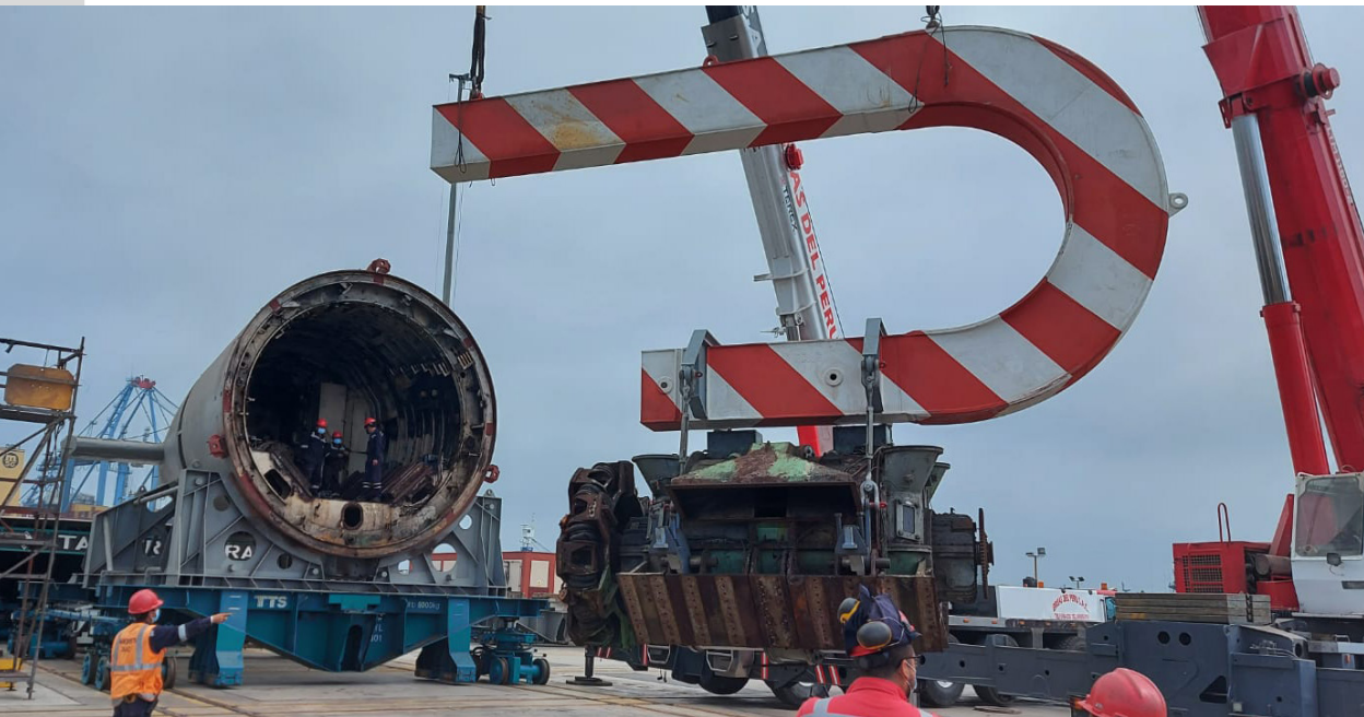
Retiro del motor eléctrico de propulsión del B.A.P. Antofagasta.
