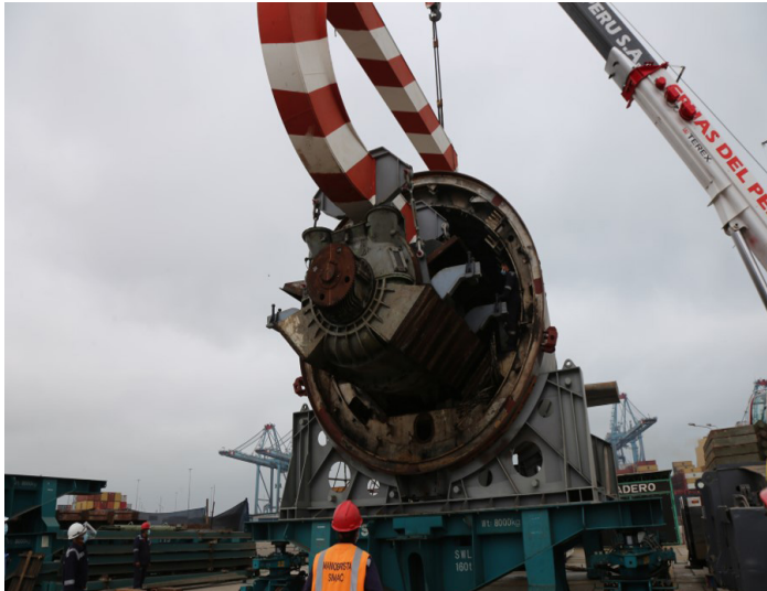
Retiro de motor a propulsión del B.A.P. Chipana .
