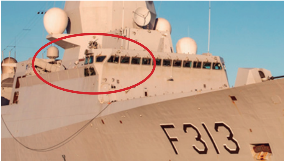
Figura 1. Alerón de estribor de una fragata clase Fridtjof Nansen. Disponible en: https://www.seaforces.org/marint/Norwegian-Navy/Frigate/F-313-HNoMS-Helge-Ingstad.htm
