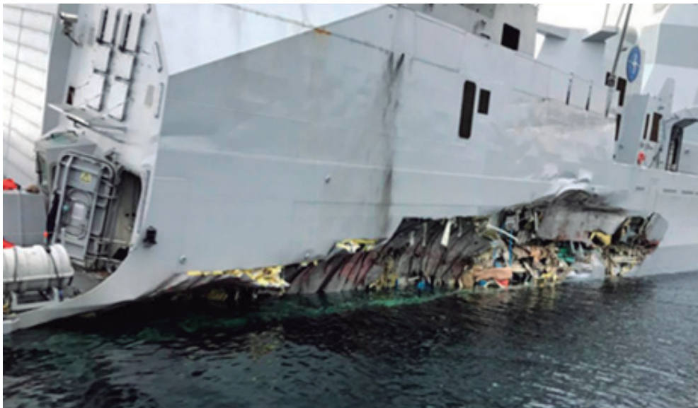
Figura 3. Daños de la fragata HNoMS Helge Ingstad . Imagen obtenida de https://www.aibn.no/Marine/Published-reports/2021-05-eng?WAF_IsPreview=true
