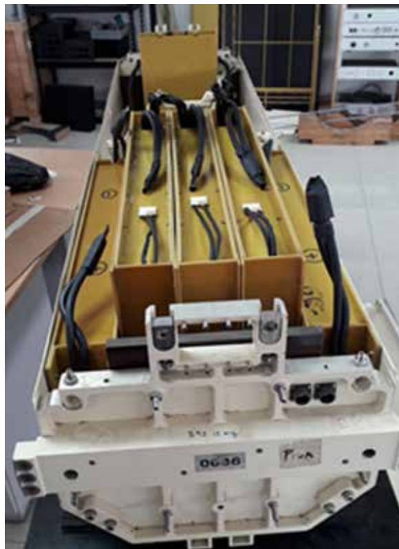
Batería de propulsión con grupos de batería de ion litio.
