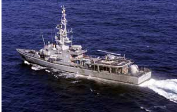
La corbeta Los Ríos (CM13) en el curso de unos ejercicios con la Armada estadounidense en 1999. Se aprecia la gran variedad de sensores y sistemas de armas instalados en relación con el reducido desplazamiento de estas unidades. Crédito: US Navy.
