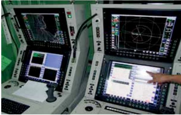
Consolas multifunción del sistema de combate Orion, integrado en las corbetas modernizadas. Crédito: ASTINAVE.
