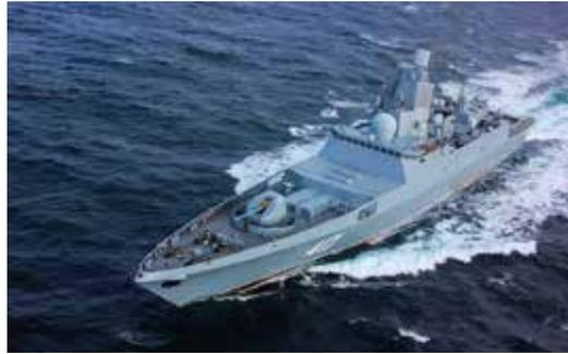
Vista frontal de la fragata *Almirante Gorshkov*. Se aprecia en primer plano el cañón A192M, seguido por las celdas para misiles antiaéreos y, detrás, las de misiles antibuque. El radomo montado sobre el puente corresponde al radar Monolit los rectángulos verticales sobre el mástil a las antenas del radar Poliment y en la cima del mismo se encuentra el radar Furke. Crédito: Ministerio de Defensa de la Federación Rusa.
