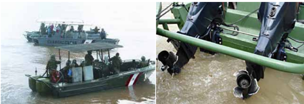
Daño a hélices por fondo bajo y rocoso en los ríos del VRAEM.
