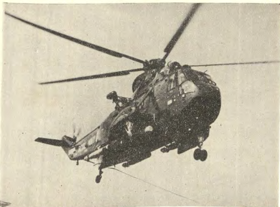
El Westland Sea King de la Royal Navy es un potente y eficaz helicóptero de lucha antisubmarina. Puede operar tanto de día como de noche y está provisto de un sistema de pilotaje automático y un equipo integrado de sonar/radar de vigilancia. Su armamento consta de cuatro torpedos Mk.44 y cuatro cargas de profundidad Mk.11.
