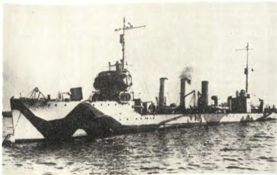
El PERKINS (DD-26) camuflado para operaciones antisubmarinas en Queenstown, Irlanda, durante la I Guerra Mundial. El puente recubierto como los cañones con torretas fueron cambios dictados por el clima severo del Atlántico Norte.
