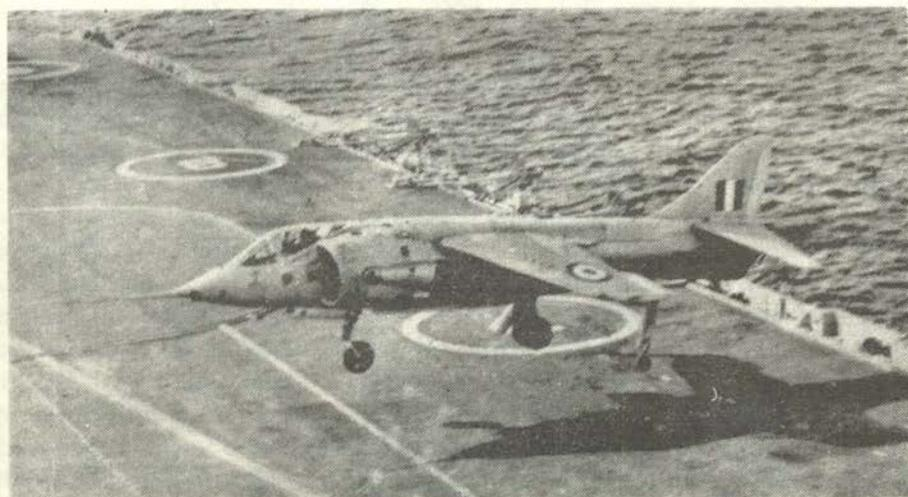
Apontaje Vertical en la cubierta del Crucero H.M.S. "BLAKE"
