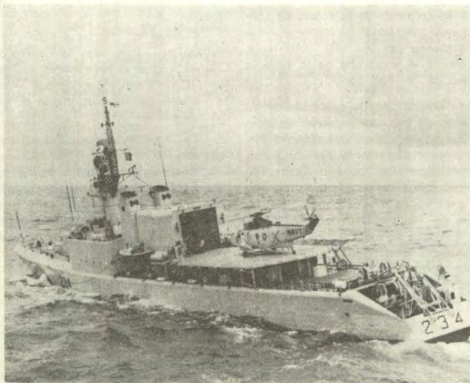
Fig. 5.—Las grampas de la trampa aprietan la probeta del "Sea King" sujetando el helicóptero de 9½ toneladas firmemente en la cubierta. Así se encuentra el helicóptero en posición para estar centrado y trasladado al hangar.
