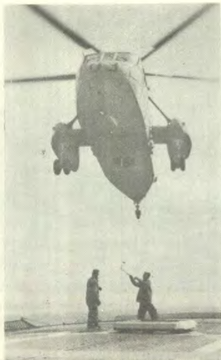
Fig. 2. —Un tripulante de la cubierta de aterrizaje conecta el cable mensajero a la cubierta mientras el otro se alista para conectar el cable de jalar abajo. El "Sea King" se cierne a 50 pies más o menos arriba de la cubierta.
