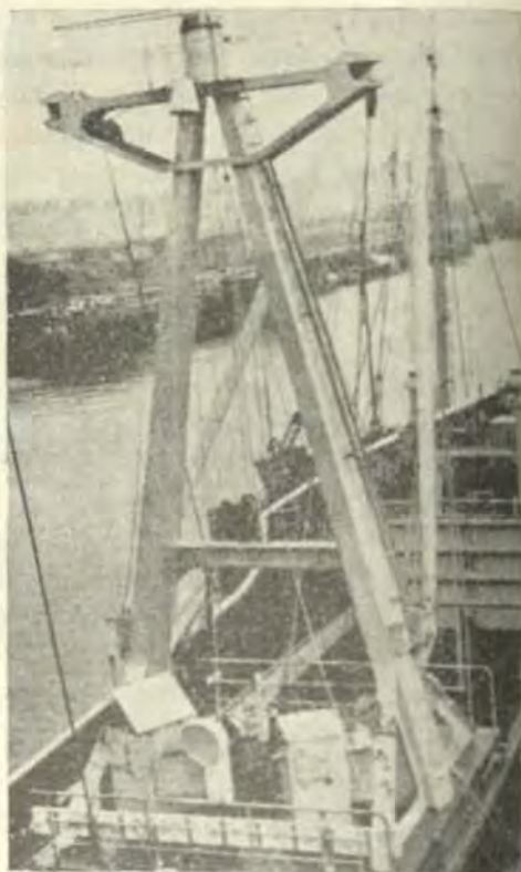
Mástil bípodo montado en plataforma rodante; ésta se desplaza rodando a todo lo largo de la bodega. (Mac Gregor Camarain).
