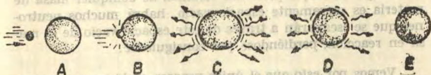
Fig. 39.—Absorción de neutrones por el Uranio sin que se produzca fisión.
