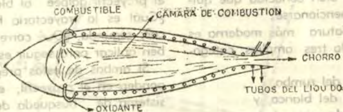
Fig. 4. COHETE A COMBUSTIBLE LIQUIDO. El combustible y el oxígeno están contenidos como líquidos. La combustión se controla regulando el flujo de los líquidos. El cohete puede necesitar equipo auxiliar para bombear y medir los líquidos. Otros motores del tipo cohete pueden quemar combustibles sólidos.
